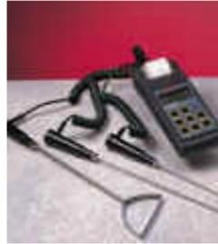
O termopar é um termómetro termoeléctrico que mede a temperatura pelo método de contacto. Este sensor de temperatura é formado pela junção de dois condutores ou semi condutores, de modo a formar um circuito fechado.
