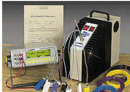
O grau de precisão exigido para a calibração determina o tipo de equipamento a utilizar. Assim, se for exigida uma precisão elevada será necessário recorrer a padrões primários que produzem os pontos da Escala Internacional de Temperaturas, enquanto que para uma calibração de rotina num laboratório de uma indústria será suficiente a utilização de calibradores que utilizem banhos com controlo de temperaturas. Um destes exemplos foi referido anteriormente, sendo muito usado nos laboratórios.
